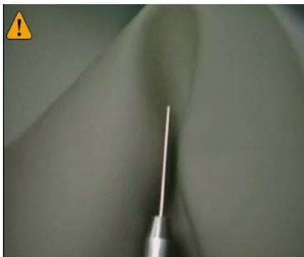
图 20 向着针的末端的方向旋转移动砂纸
