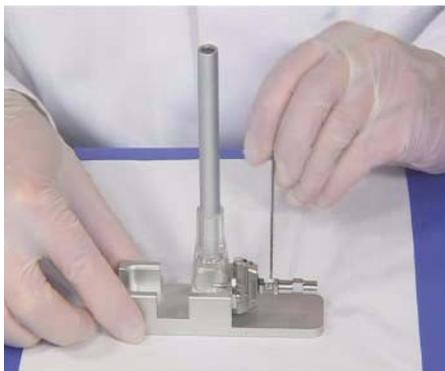
图 18 将雾化器安装到调整夹具中
