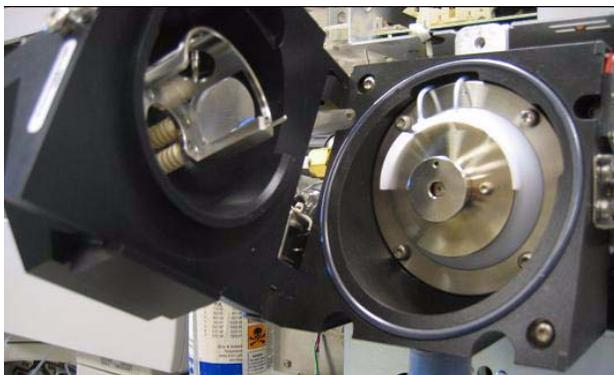
图 1 打开的电喷雾雾化室
