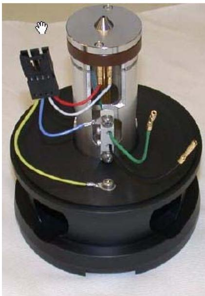
**图 40** 重新组装的离子光学组件
