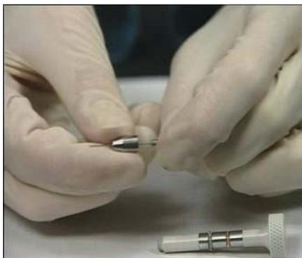
图 21 将新针装入套筒
