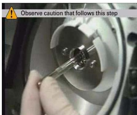
图 22 从去溶剂化组件中抽出毛细管
