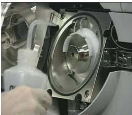
图 4 冲洗雾化护罩的周边区域
